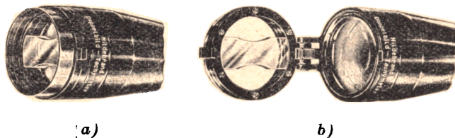
Obr. 111. Arregerův dvojobrazový dálkoměr a) přiklopený, b) odklopený.
