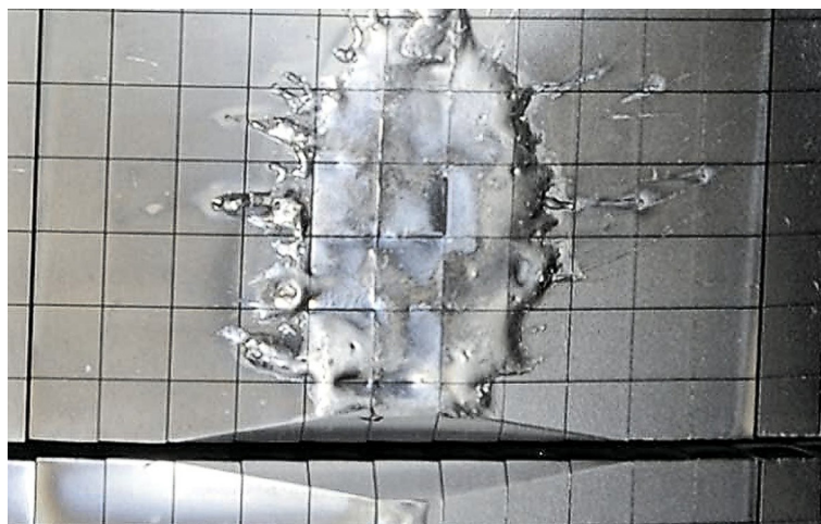
Obr. 1. Dnes už legendární snímek poškození vnitřní části komory tokamaku JET způsobeného ubíhajícími elektrony [4]
