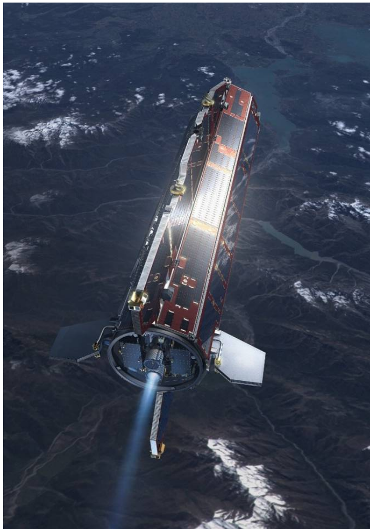
Obr. 10. Družice GOCE na oběžné dráze (malířova představa). Štíhlý, aerodynamický tvar pět metrů dlouhého tělesa družice bez obvyklých pohyblivých částí byl mezi družicemi unikátní. Proto byl GOCE nazván v tisku „ferrari“ mezi družicemi. © ESA/AOES Medialab.
