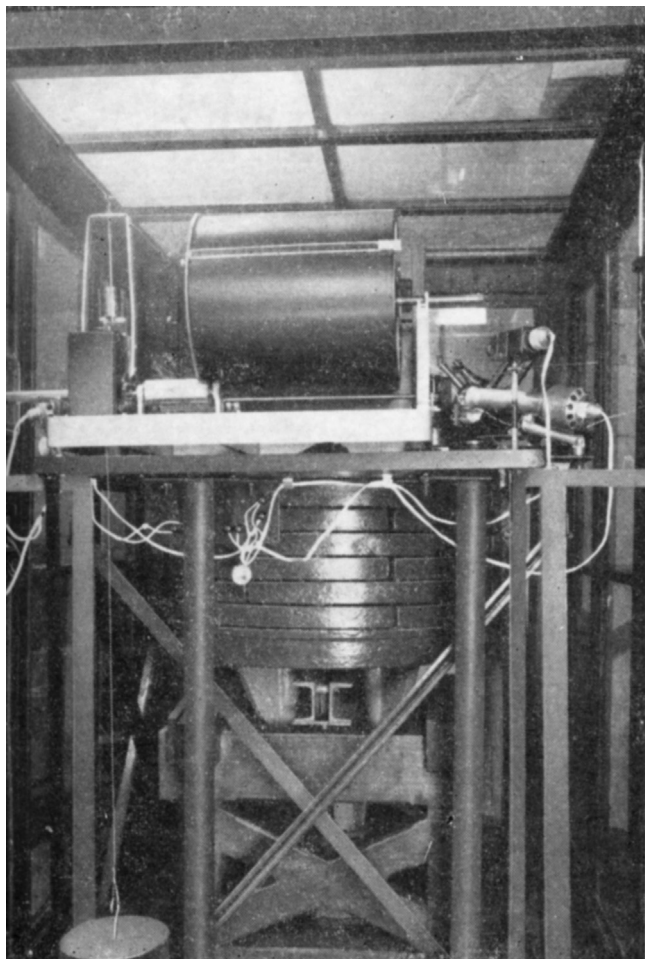
Obr 1. Wiechertovo astatické horizontální kyvadlo. Foto převzato z informační brožury MFF UK z roku 1974, v tu dobu byl však přístroj již rozebrán.
