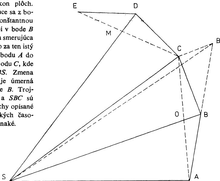
Spojnica  $AC$  pretína sprievodič  $SB$  v bode  $O$ , pričom  $OB = \frac{1}{2}B'C$ , a preto úsečku  $OB$  môžeme považovať za úmernú dosťredivej sile v bode  $B$ . V ďalšom časovom intervale nech teleso prejde z bodu  $C$  do bodu  $D$ . V tomto bode môžeme úvahu v bode  $B$  zopakovať a zostrojiť bod  $M$  analogický bodu  $O$ . Ak má platiť, že odstredivá sila je nepriamo úmerná štvorcu sprievodiča, musí platiť
