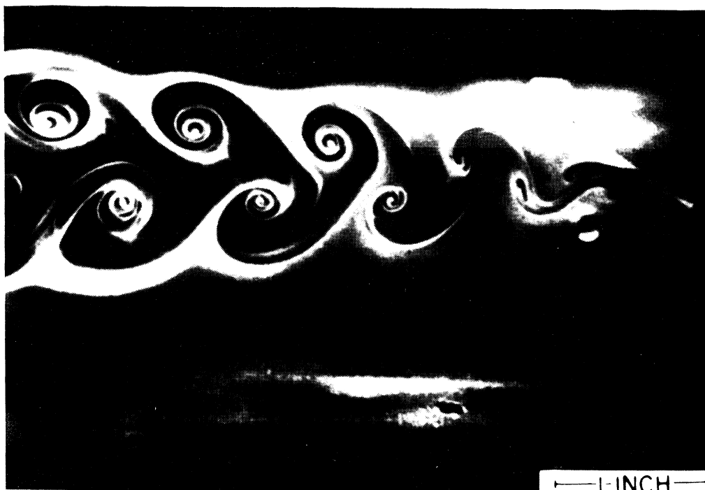
Obr. 36. Proud vzduchu za pohybujícím se válcem vytváří podélnou řadu vrcholů. Průřez těchto vrcholů je zviditelněn vstříknutím kouře do středu větrného tunelu.
