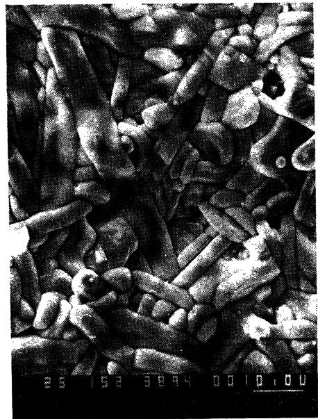
Obr. 6. Fotografie mikrokrystalické struktury keramiky \text{YBa}_2\text{Cu}_3\text{O}_{7-y} [28]. Úsečka v dolní části obrázku představuje měřítko 10 \mu\text{m} .
