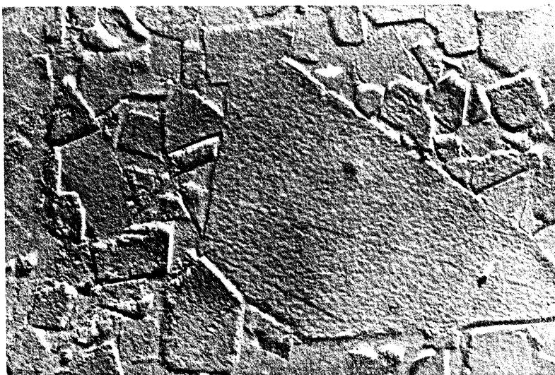
Obr. 2. Struktura soustavy 94% WC + 6% Co. Zvětšení 12000 \times . Snímek obsahuje extrémně velkou částici karbidu wolframu vzniklou koalescencí.
