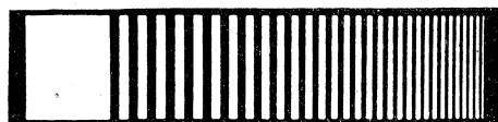
Obr. 2 Pravoúhlý paralelní test s prostorovou frekvencí měnící se podle geometrické řady, jehož bylo použito při měření
