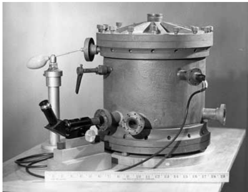
Obr. 5: Millikanův originální přístroj na měření náboje elektronu [5]
