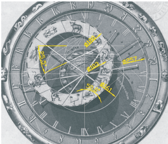
Obr. 4. Kresba astrolábu v knize Beschreibung der alterhümlichen prager Rathhaus-Uhr z roku 1866. Autorem nebo zadavatelem kresby je pravděpodobně předseda komise pro opravu orloje, profesor astronomie J. G. Böhm. I zde konstrukce odpovídá sklonu zemské osy k ekliptice cca 25,5^\circ . Kružnice horizontu zde chybně neprotíná průsečík rovníku s vodorovnou přímkou procházející středem astrolábu a neodpovídá horizontu konstruovanému pro 50^\circ s.š.
