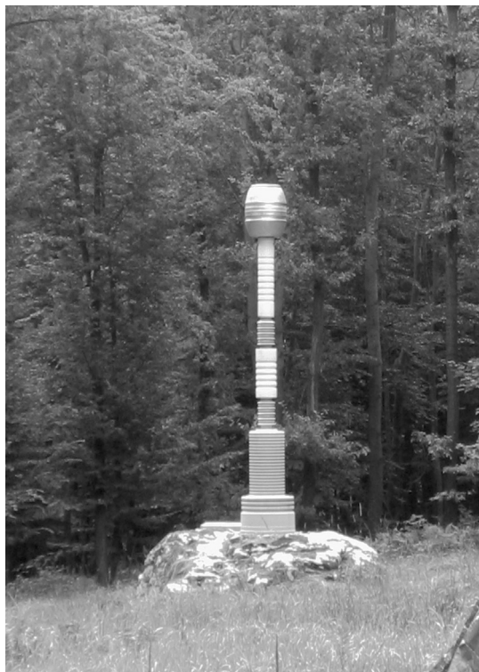
Obr. 6. Anténa kapacitného typu („ball antenna“) pre snímanie vertikálnej elektrickej zložky poľa v pásme Schumannových rezonancií na AGO Modra. Výška stožiara antény je 5.5 m, tesne pri báze antény je umiestnená skrinka pre zosilňovač, napájacie a signálové privody sú uložené pod zemou a vedú na vzdialenosť asi 150 m.
