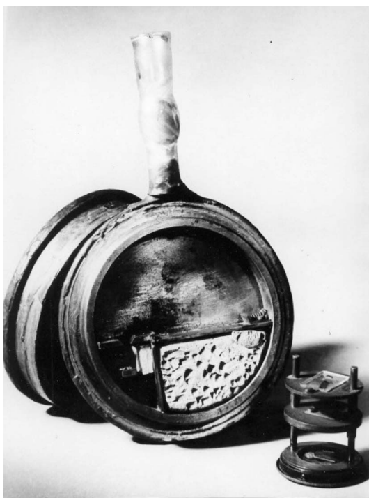
Obr. 1. Jeden z prvních spektrografů záření \beta , kterým Otto Hahn, Liese Meitnerová a Otto von Baeyer zkoumali elektronové záření radionuklidů. Originál je vystaven v Německém muzeu v Mnichově, odkud je i tento snímek. Vidíme otevřenou vakuovou komoru o průměru asi 15 cm, která se vkládala do homogenního magnetického pole. V pravém dolním rohu je stojánek pro absorpční měření.
