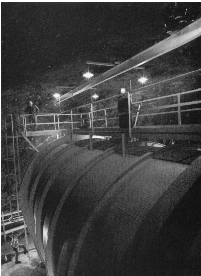
Obr. 2. První detektor slunečních neutrin, který vybudoval Raymond Davis, Jr. v hloubce 1500 m ve zlatém dole Homestake v USA. Na obrázku stojí Davis na lávce nad nádrží obsahující 380 000 litrů tetrachlorethylenu. (Foto BNL.)
