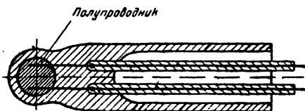
Obr. 5. Konstrukce mikrothermistoru V. G. Karmanova. (Полупроводник = polovodič)
